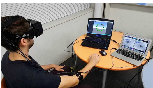
Slika 1.1. Suvremeno praćenje pogleda pomoću EMG-a i VR-a [17]
