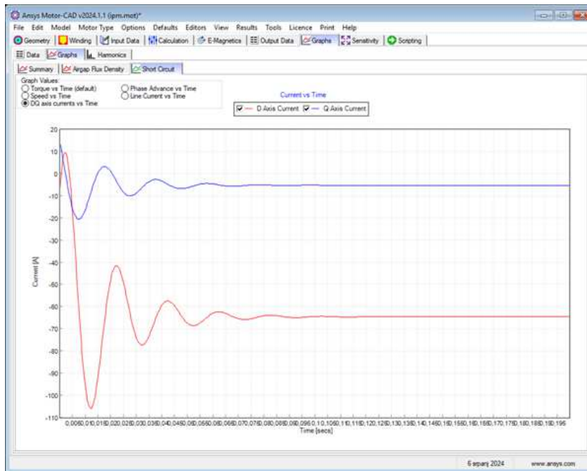
Slika 3.19. Rezultat simulacije kratkog spoja u MotorCAD-u
