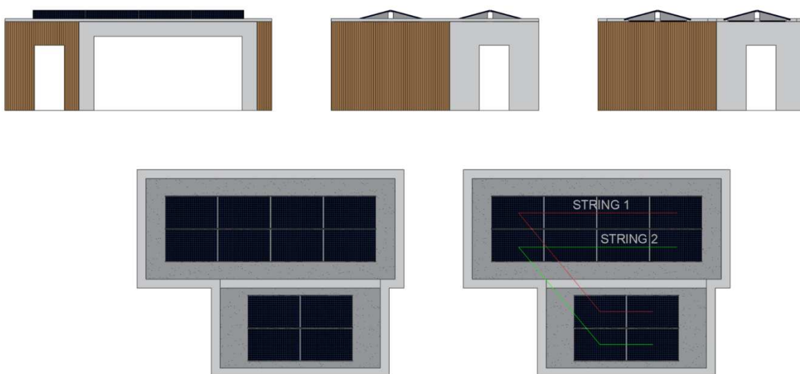
Sl. 3.12 Nacrt, bokocrt, tlocrt MH - dvosmjerna orijentacija FN modula – Model MH1
