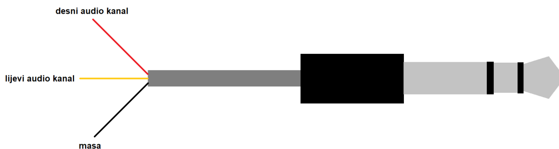
Slika 3.3. Struktura 3.5mm audio kabela
