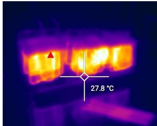
Slika 6.9: Termografika snimka otpornika za vrijeme mjerenja
