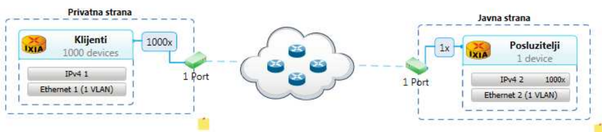
Slika 4: IXIA topologija za mjerenje performansi prevoditelja
