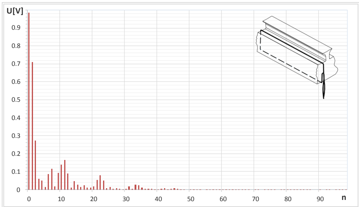
Slika 6.57. Frekvencijska analiza valnog oblika napona induciranog u mjernom svitku M_{s3} i M_{s4} , na polnom koraku pola broj 4, uz sniženi broj zavoja pola broj 4 od 10 %, pri uzbudnoj struji 8,7 A.
