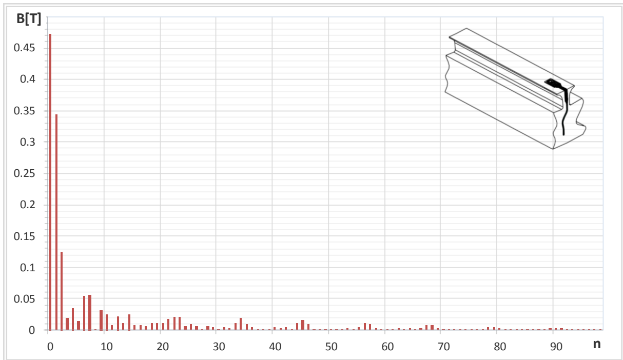
Slika 6.21. Frekvencijska analiza raspodjele magnetske indukcije na polnom koraku, u zračnom rasporu promatrane sa zuba statorskog paketa.
