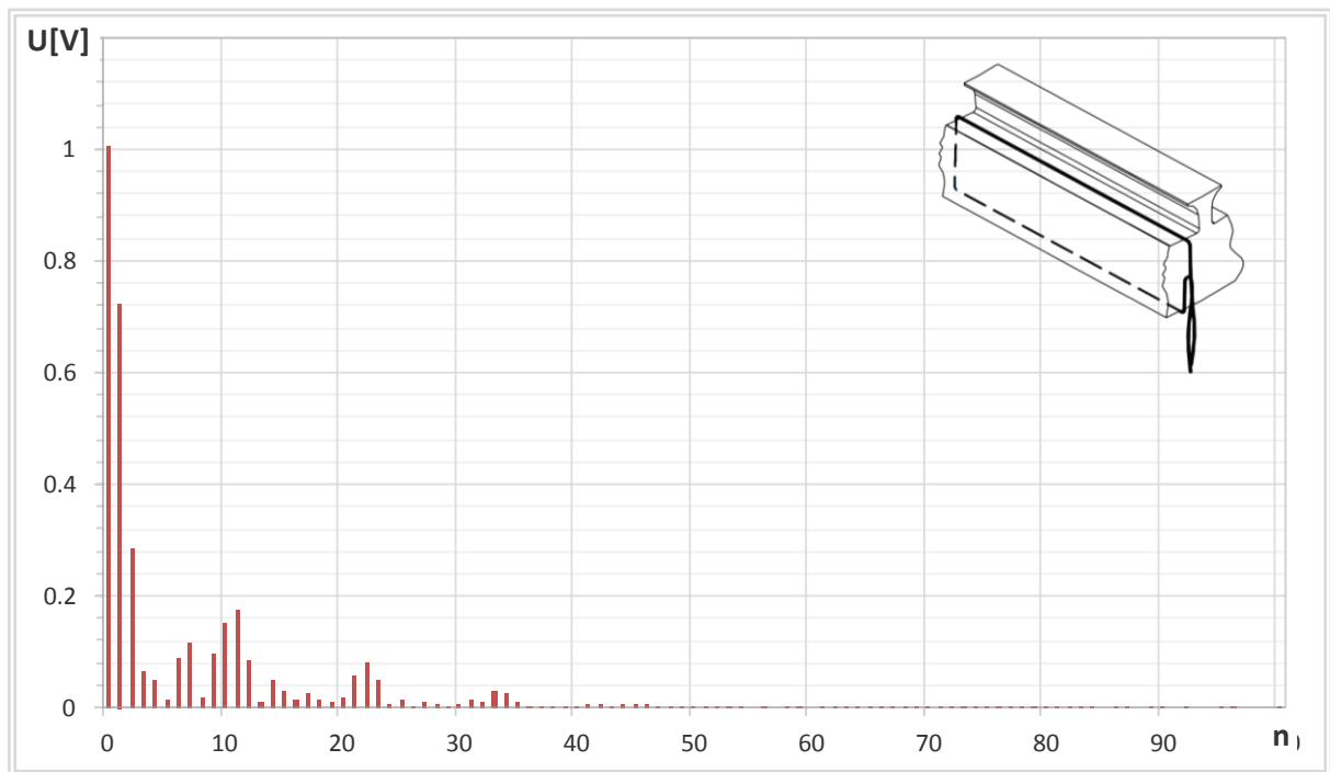
Slika 6.26. Frekvencijska analiza valnog oblika napona induciranog u mjernom svitku Ms_3 i Ms_4 , prikazanog na slici 6.18.
