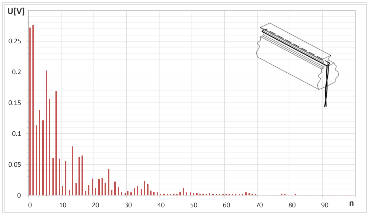
Slika 6.22. Frekvencijska analiza valnog oblika napona induciranog u mjernom svitku Ms_1 i Ms_2 , na polnom koraku, prikazanog na slici 6.12.
