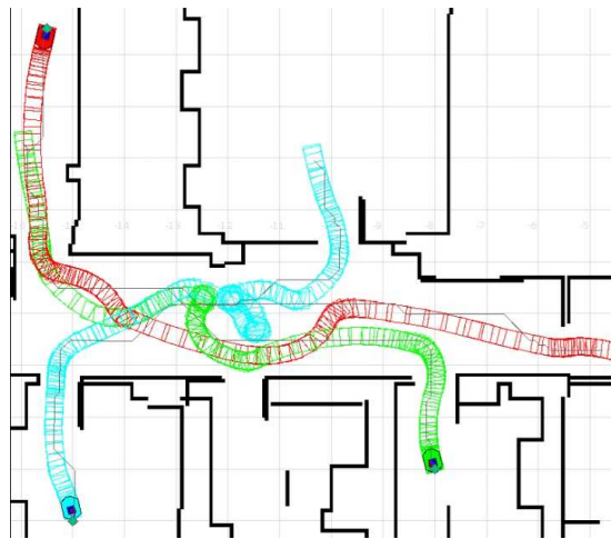
Slika 5.17. Putanje triju robota upravljanih izvornim objedinjenim algoritmom.
