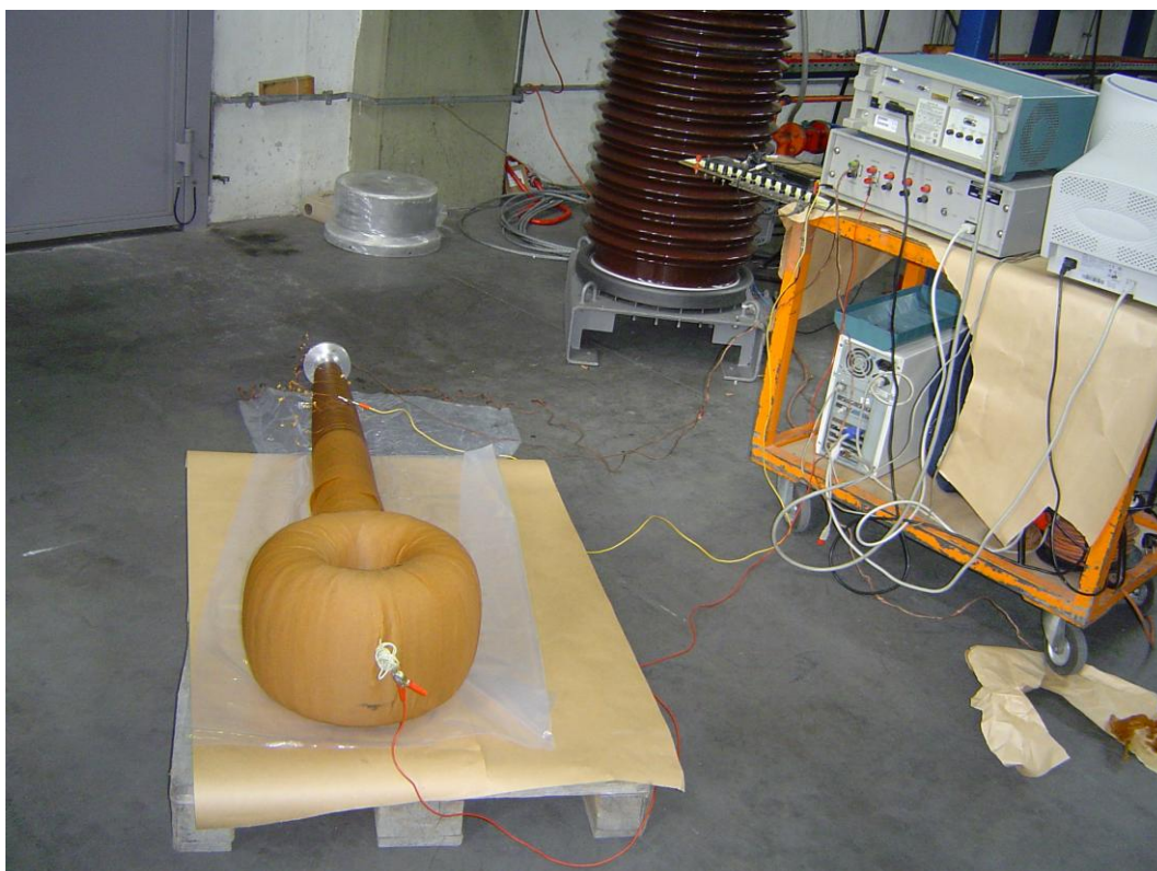
Slika 2.9 – Mjerenje raspodjele udarnih napona duž izolacijskog sustava strujnog transformatora U_m=123 kV nakon impregnacije
