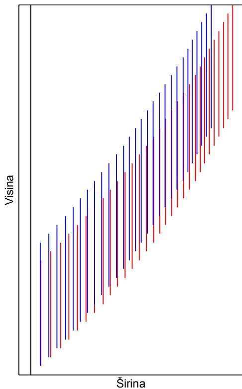
Slika 6.6 – Obloge postojećeg (crvene) i optimiranog (plave) izolacijskog sustava dobivenog korištenjem potprograma OPTIZO\_1
