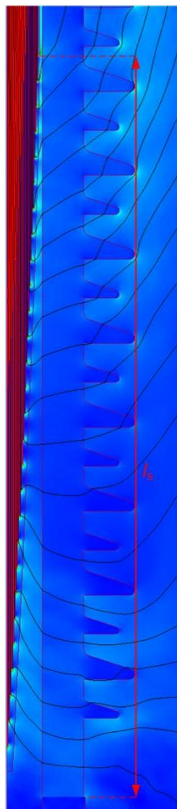
Slika 6.10 – Rezultat numeričkog proračuna električnog polja za optimiranu inačicu
