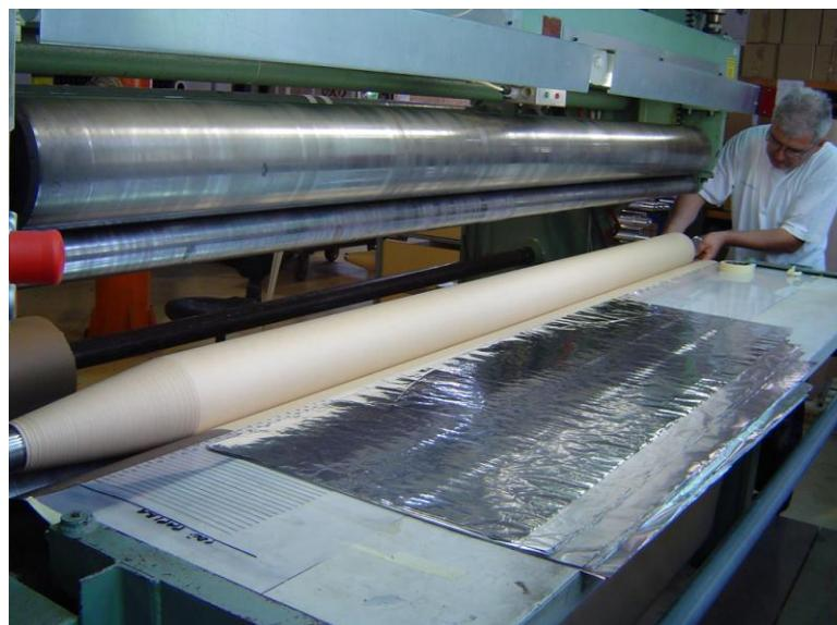
*Slika 7.16 – Namatanje kondenzatorskog tijela 245 kilovoltnog provodnika*
