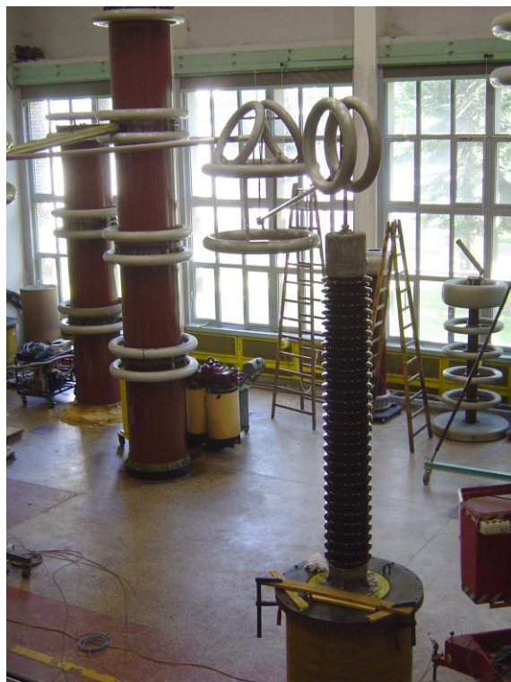
Slika 7.18 – Ispitivanje 245 kilovoltnog provodnika izmjeničnim naponom
