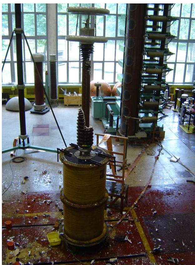
Slika 4.6 – Rasprsnuće porculanskog izolatora transformatorskog provodnika
