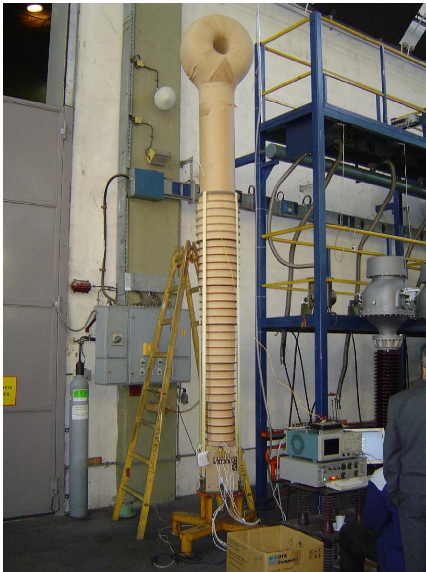
Slika 2.10 – Mjerenje raspodjele udarnih napona duž izolacijskog sustava kombiniranog transformatora U_m=420 kV prije impregnacije
