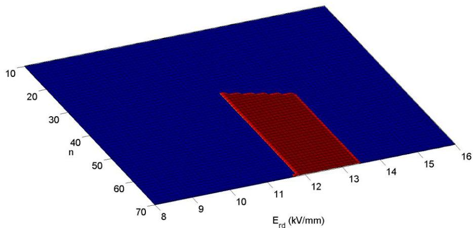
*Slika 7.7 – Kombinacije ulaznih parametara za koje su pronađeni sustavi za koji zadovoljavaju s obzirom na  $l_{1,\max}$ ,  $r_{n,\max}$  i  $E_{o,\max}$*
