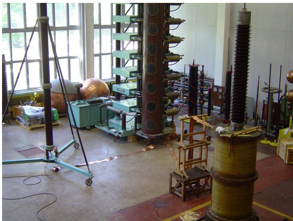
Slika 7.17 – Ispitivanje 245 kilovoltnog provodnika udarnim naponima
