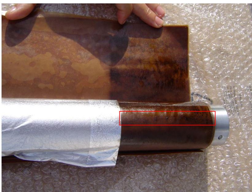
Slika 3.12 - Model br. 3 klizna staza parcijalnog proboja
