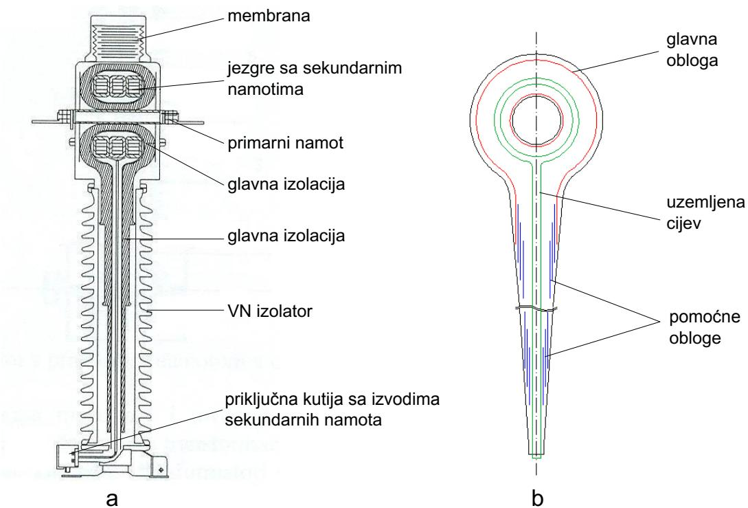
Slika 2.7 - Inverzni tip strujnog transformatora
