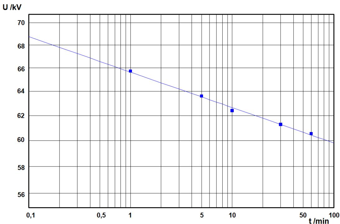
Slika 3.14 – Apsolutna volt-sekundna krivulja modela provodnika za  $P=50\%$
