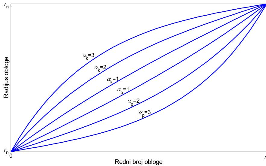
Slika 5.9 – Funkcija ovisnosti radijusa obloge o parametrima  $\alpha_p$  i  $\alpha_k$ , 0-ta obloga je uzemljena cijev
