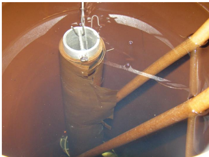
Slika 3.8 - Model br. 1 nakon proboja atmosferskim udarnim naponom
