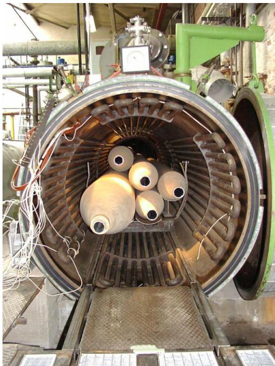
Slika 2.1 – Kondenzatorska tijela provodnika u peći za sušenje
