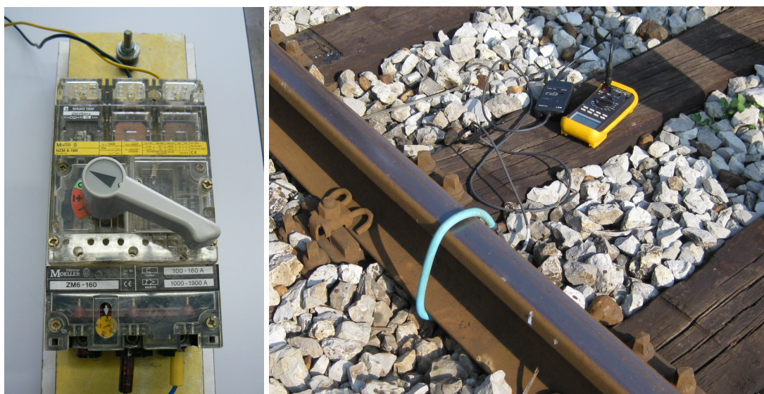
Slika 3.11. Sklopka za uklop i isklop strujnog kruga i svitak Rogowski za mjerenje struje povratnog voda
