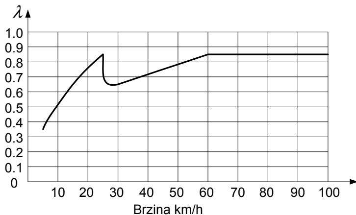
Slika 3.3. Krivulja faktora snage \lambda elektromotornoga vlaka
