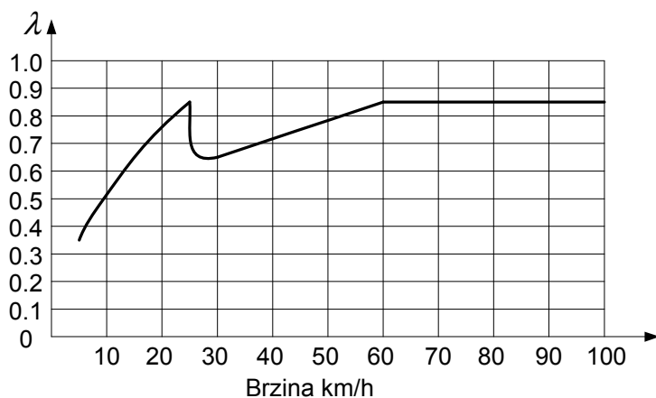
Slika 3.3. Krivulja faktora snage \lambda elektromotornoga vlaka
