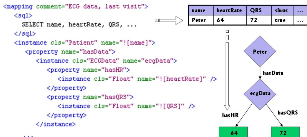
Slika 5.5. Primjer formalizma koji preslikava podatke dohvaćene SQL upitom u strukturu definiranu ontologijom.
