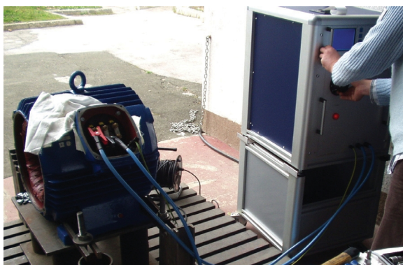
Slika 4.1. Mjerna oprema za ispitivanje dielektričke čvrstoće asinkronog „Ex e“ motora (380 V, 47 kW)
