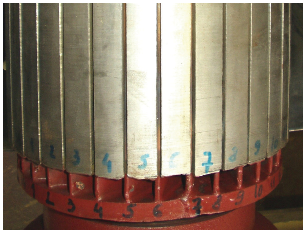
Slika G.1. Ispravan (servisiran) kavez rotora
