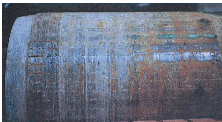
Slika E.2. Oštećenje lijevanog aluminijskog kaveza
