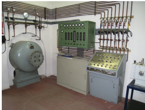
Slika H.1. Miješalica za namješavanje eksplozivne smjese LUDEWIG & TILLMAN
