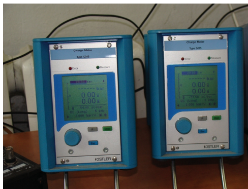
Slika H.3. Davači (pretvornici) tlaka i sustav/uređaj za mjerenje tlaka eksplozije KISTLER
