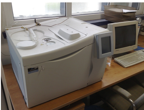
Slika H.2. Kromatograf za kontrolu sastava eksplozivne smjese PERKIN ELMER
