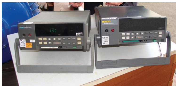
Slika 6.2. Ispitna oprema za mjerenje zagrijavanja elektromotora
