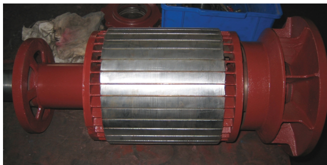
Slika 4.3. Kavez rotora elektromotora (380 V, 47 kW, Ex e II T1/T2/T3)
