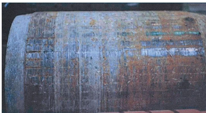
Slika E.2. Oštećenje lijevanog aluminijskog kaveza
