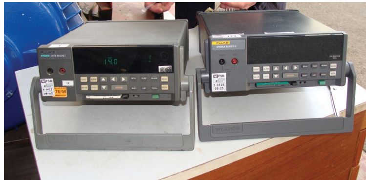
Slika 6.2. Ispitna oprema za mjerenje zagrijavanja elektromotora
