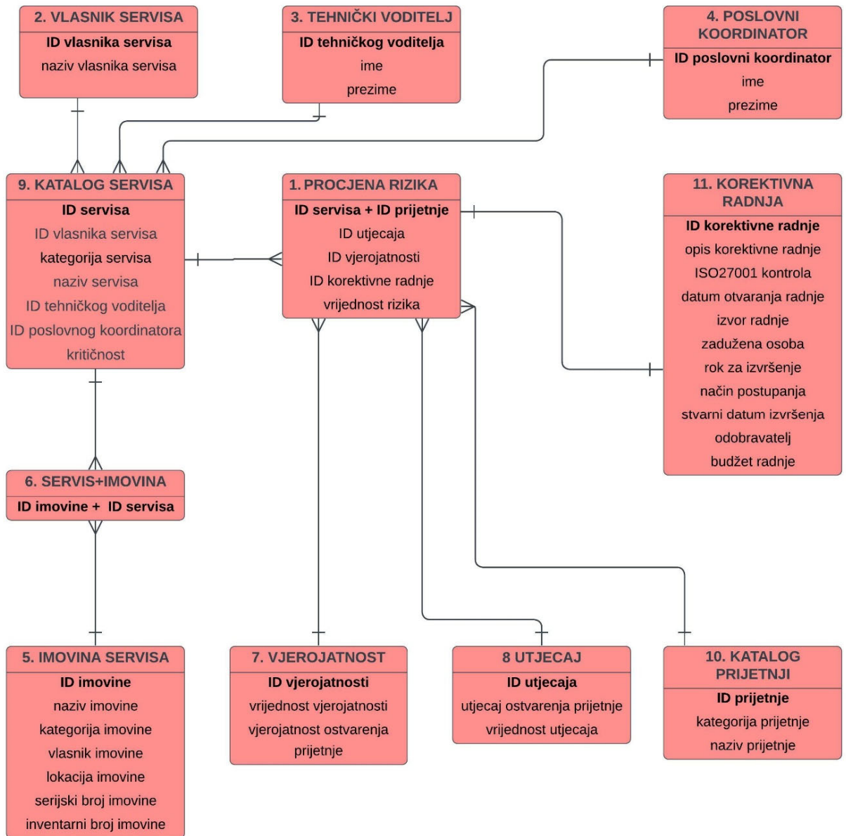
Slika 1 - Dijagram entiteti-veze konceptualnog modela baze podataka
