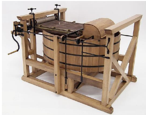
Slika 3 Model prvog stroja za izradu papira [7]
