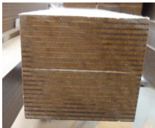
Slika 21 Delaminacija jednog sloja
