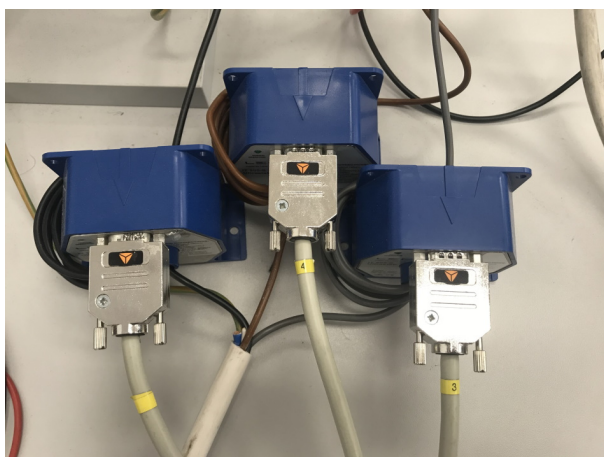
(a) Mjerni pretvornici LEM IT 205-S ULTRASTAB
