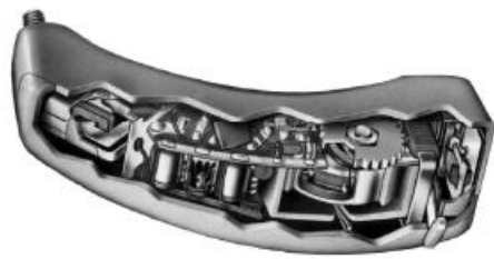
slika 1.6: Widex Minarette, zaušno analogno slušno pomagalo iz 1960. godine. [5]
