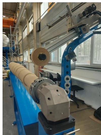
(c) namatanje glavne izolacije
