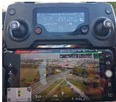
Slika 4.18 RC i mobilni uređaj bežično spojeni s dronom
