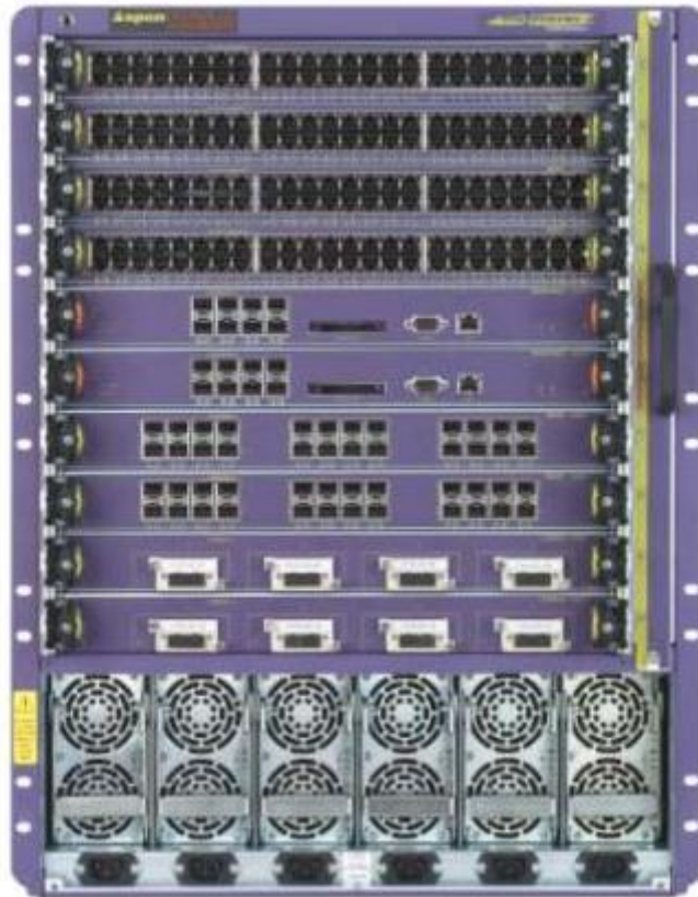
Slika 5.2. Black Diamond 8810 Ethernet preklopnik [7]
