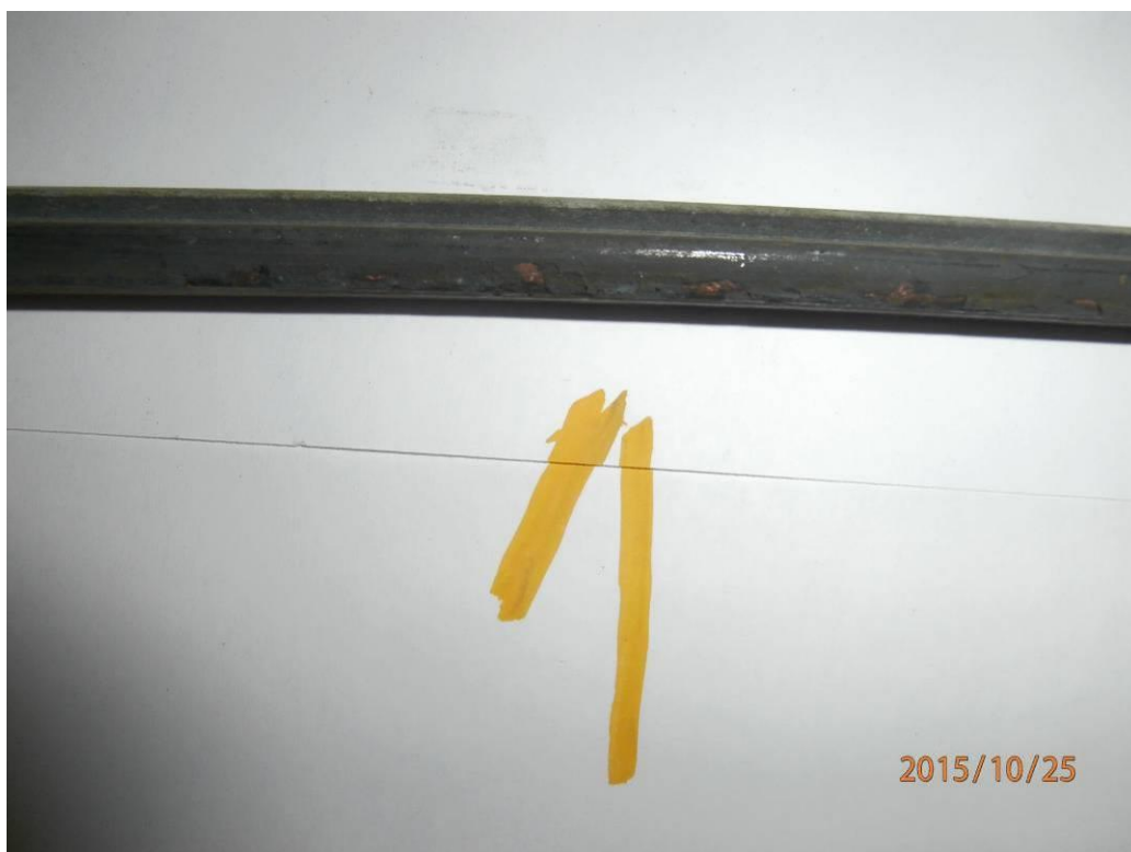
Slika 7.3. Uzorak 1 – aktivni dio eksploatiranog vodiča
