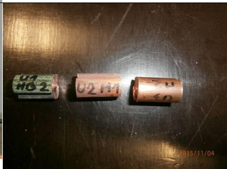
Slika 7.19. Uzorci za mjerenje tvrdoće presjeka
