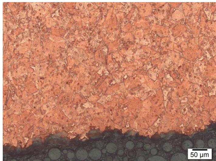
Slika 7.30. Uzorak U-1 - Rub uzorka na kojem se vide oštećenja koja su posljedica atmosferskog djelovanja
