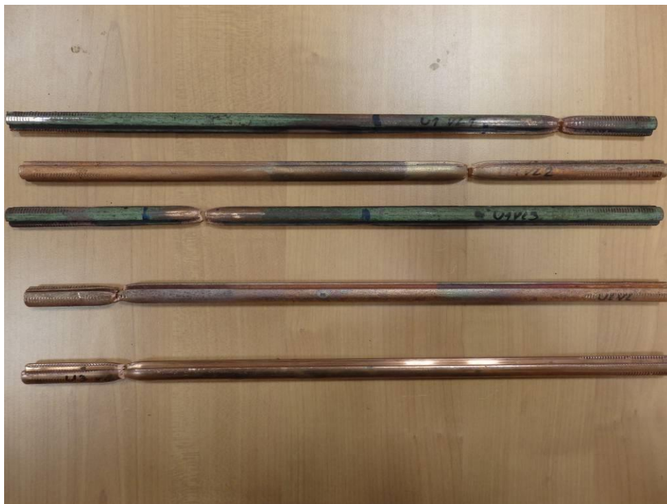
Slika 7.16. Uzorci nakon vlačnog pokusa
