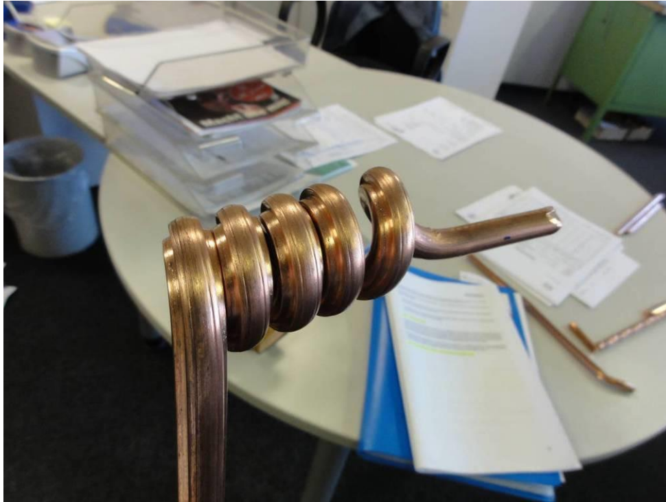
Slika 4.4. Uzorak ispitivan na namatanje
