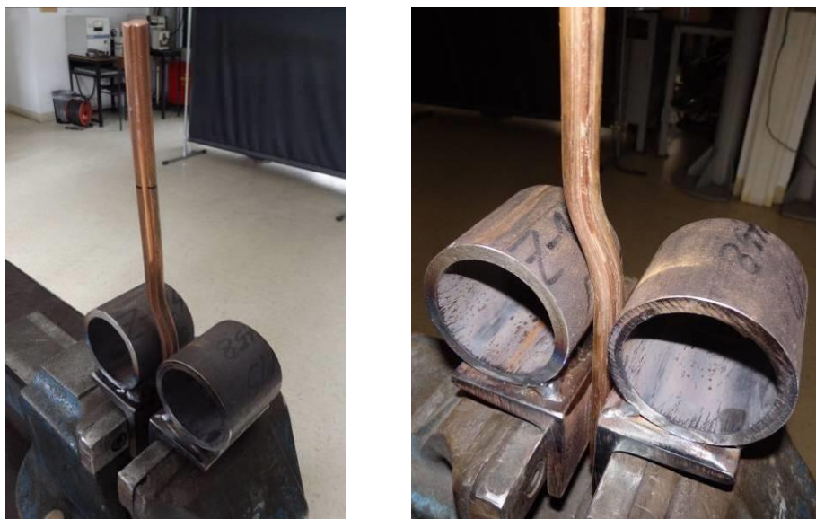
Slika 7.20. Uzorak u napravi za vrijeme ispitivanja previjanjem
