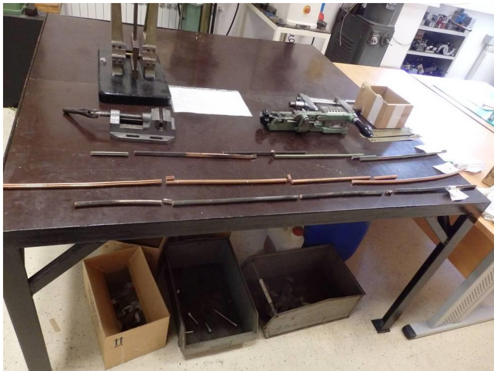
Slika 7.11. Prikaz izrezanih epruveta
