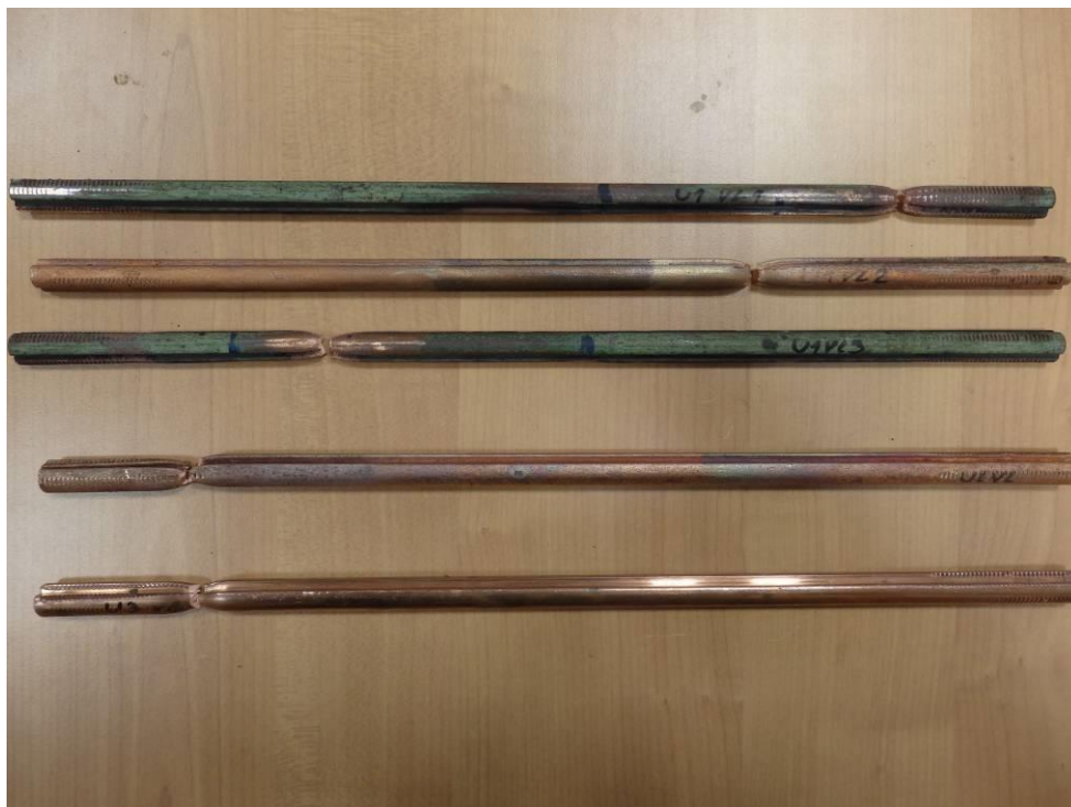
Slika 7.16. Uzorci nakon vlačnog pokusa
