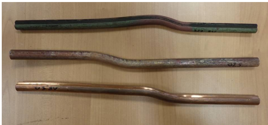
Slika 7.21. Uzorci nakon ispitivanja previjanjem
