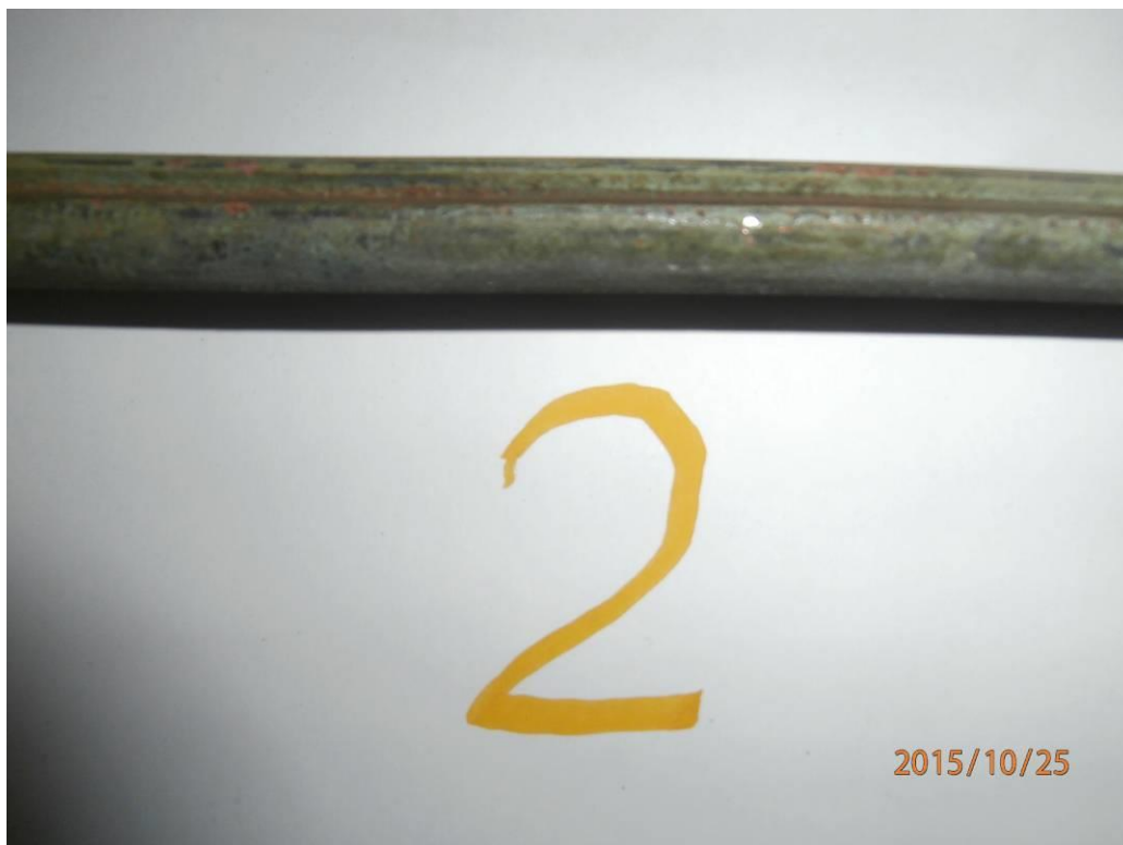
Slika 7.4. Uzorak 2 – neaktivni dio eksploatiranog vodiča
