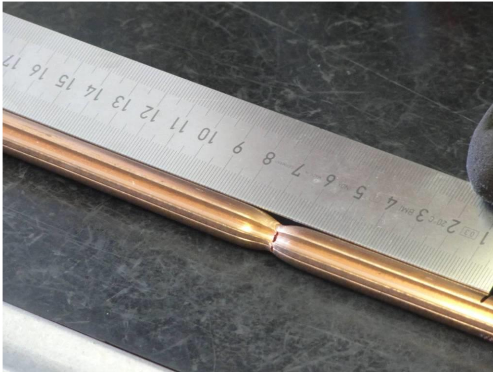
Slika 4.2. Mjerenje postotka istezanja na puknutom uzorku
