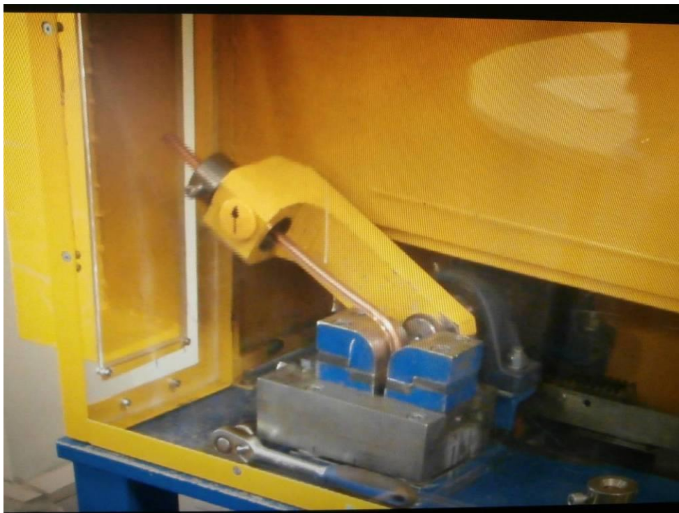
Slika 4.3. Ispitivanje na izmjenično savijanje
