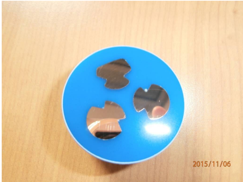
Slika 7.26. Uzorci pripremljeni za makroskopsko i mikroskopsko ispitivanje.
