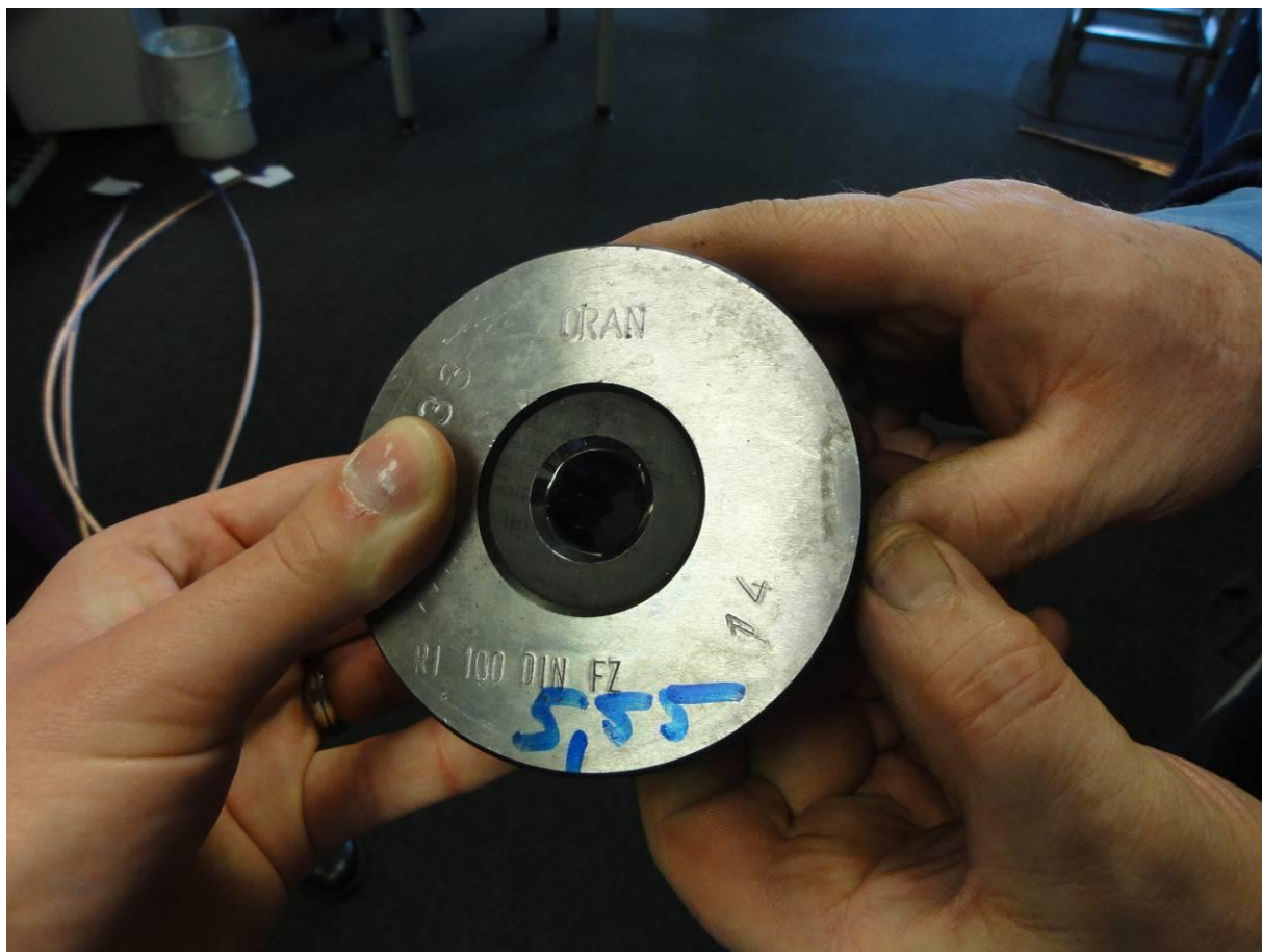
Slika 4.8. Šablona za dobivanje profila kontaktnog vodiča
