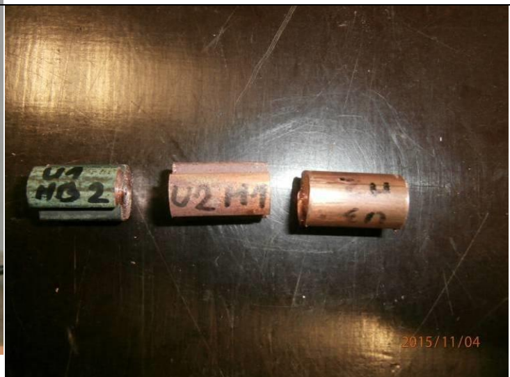
Slika 7.19. Uzorci za mjerenje tvrdoće presjeka
