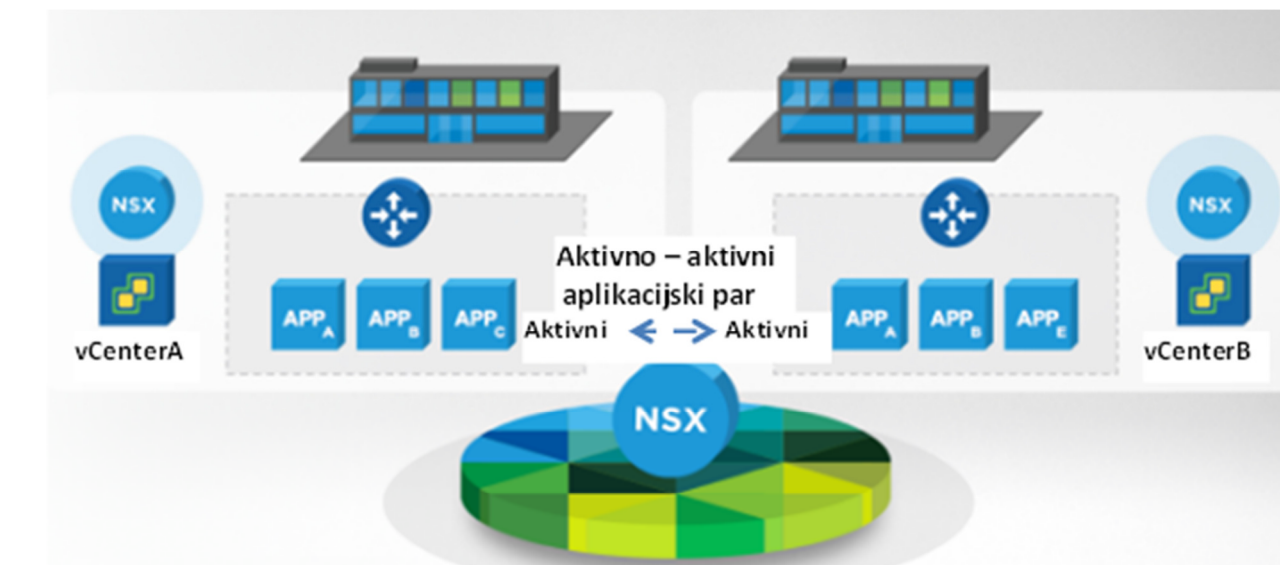
Slika 27 – Aktivno/aktivna VMware NSX implementacija primarnog i pričuvnog podatkovnog centra [68]
