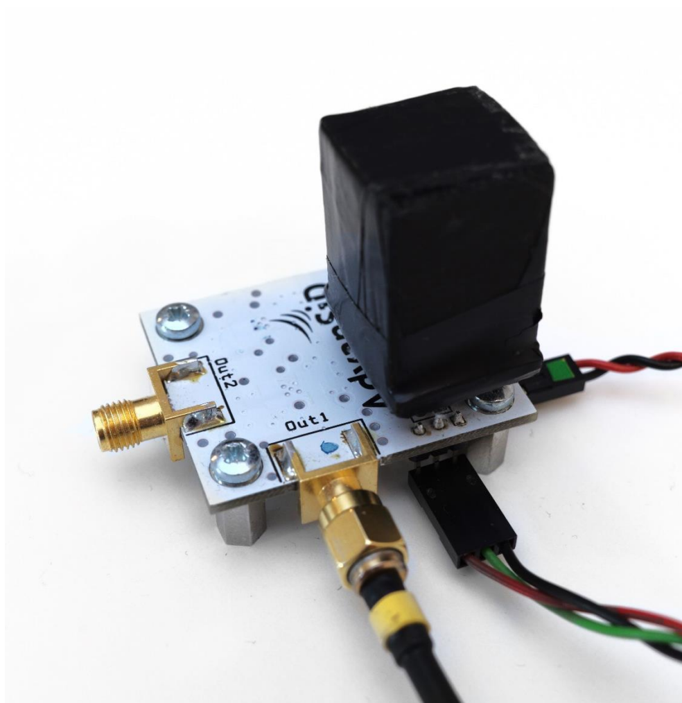
Slika 5.10: Detektorski modul spojen na pojačalo signala.
