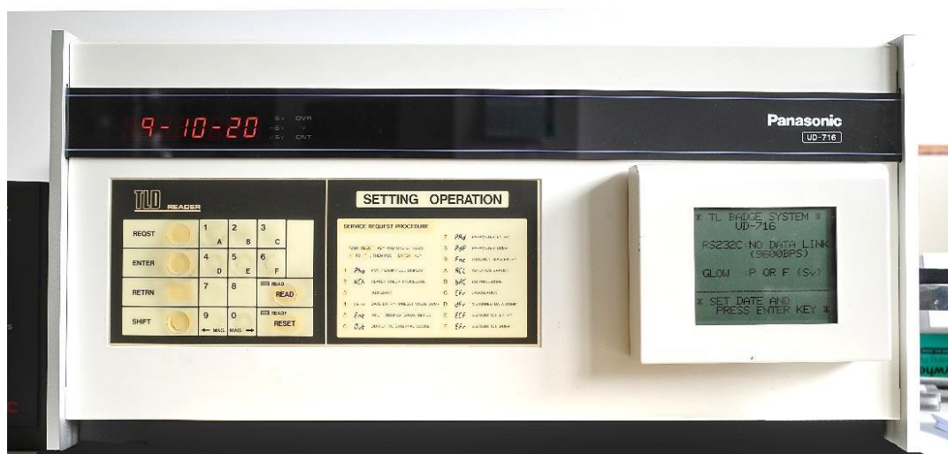
Slika 2.9: Čitač termoluminiscentnih dozimetara.
