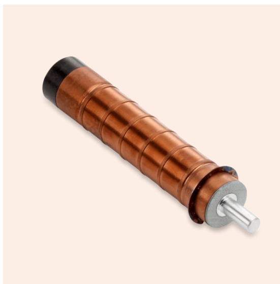
Slika 2.16: Geiger Müllerova cijev [42].
