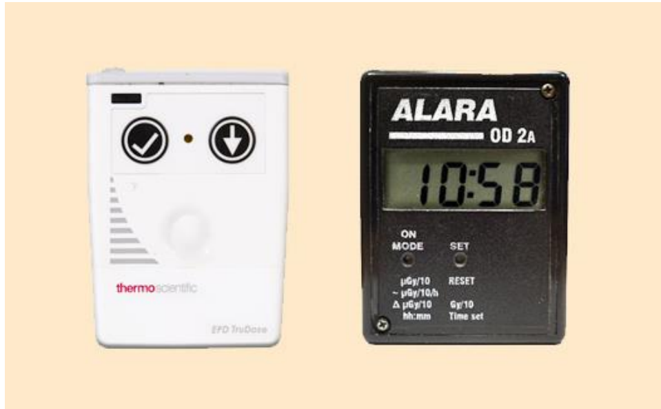
Slika 2.10: Elektronički osobni dozimetri: lijevo Thermo Scientific TruDose [31], desno ALARA OD 2A.
