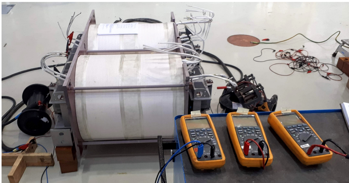
Slika 7.22: Mjerenje raspodjele struja kroz paralelno spojene svitke VN namota jednofaznog vučnog transformatora
