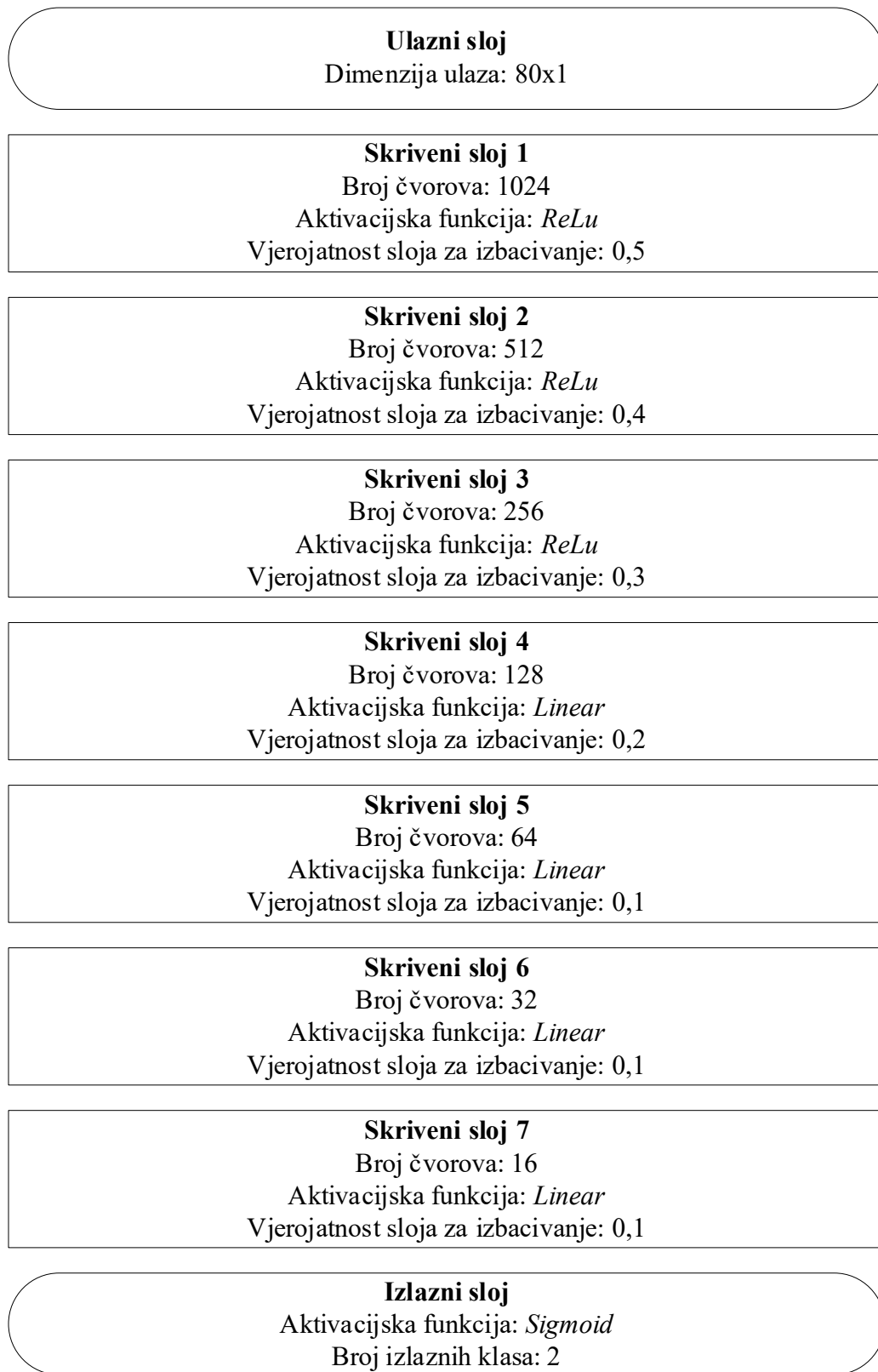
Slika 6.1. Arhitektura dubokog modela predloženog u [20]
