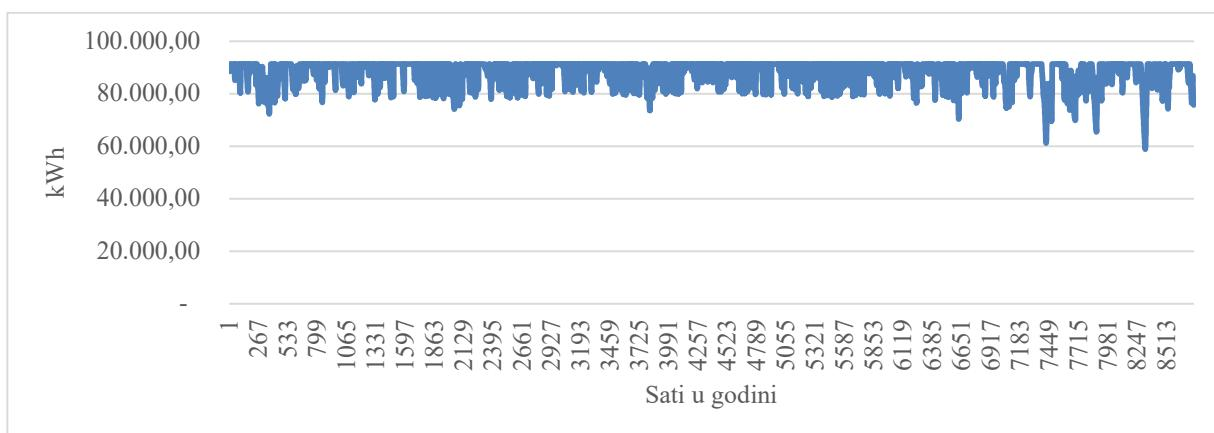
Slika 7.20: Dinamika spremnika tijekom 5. simulirane godine
