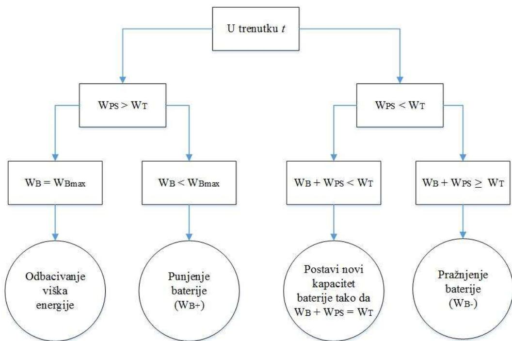
Slika 2.18: metodologija dimenzioniranja kapaciteta spremnika energije
