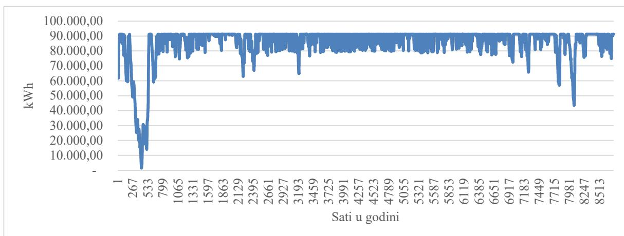
Slika 7.17: Dinamika spremnika tijekom 2. simulirane godine
