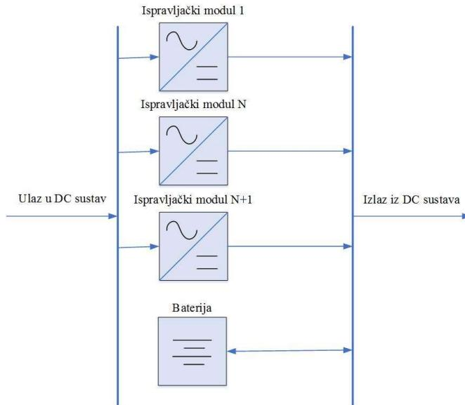
Slika 3.9: Istosmjerni sustav
