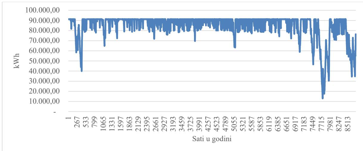
Slika 7.25: Dinamika spremnika tijekom 10. simulirane godine
