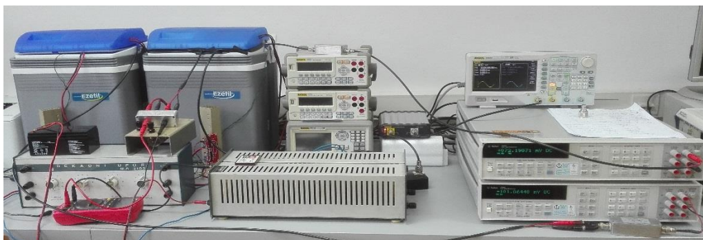
Slika 3.15 Mjerna oprema za određivanje PCR-a strujnih shuntova [31]
