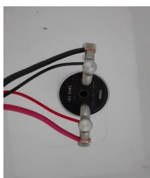
Slika 3.9 Etalonski otpornik unutar zračne komore
