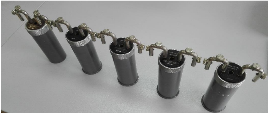
Slika 3.5 L&N grupa etalonskih otpornika iznosa od 1 Ω do 10 kΩ
