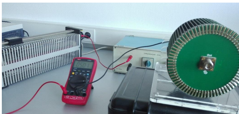
Slika 3.2 Mjerni strujni krug za praćenje temperaturne distribucije pomoću termičke kamere (za shuntove sa 70 rebara)
