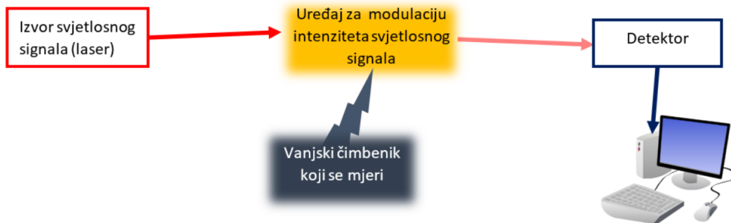
Slika 1.1: Principijelna shema svjetlovodnih senzorskih sustava temeljenih na modulaciji intenziteta signala (IBS) [3]
