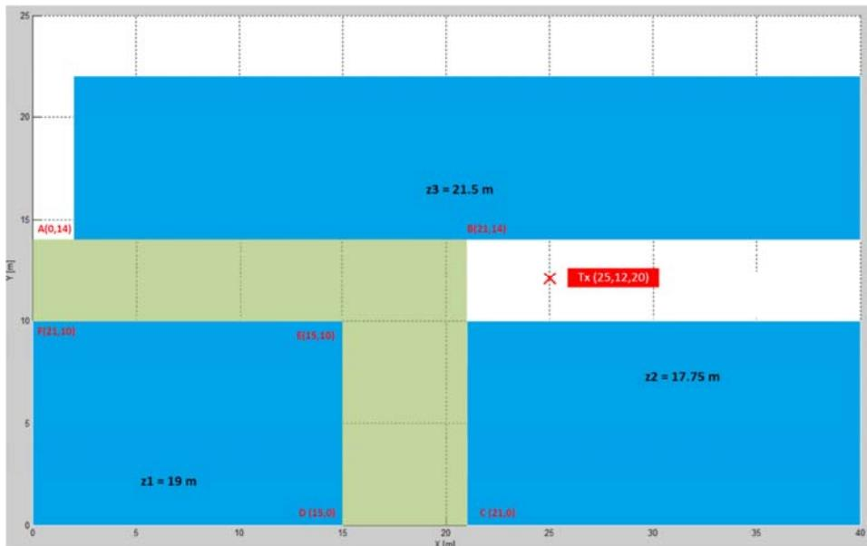
Slika 4.3 Prikaz testnog okruženja s 3 zgrade visine 19m, 17.75m i 21.5m i dimenzija  $40 \times 25\text{ m}$
