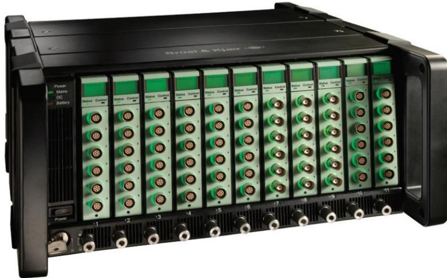
Slika 3.24 Mjerna stanica *PULSE* s *LAN-XI* procesnim modulima [40]
