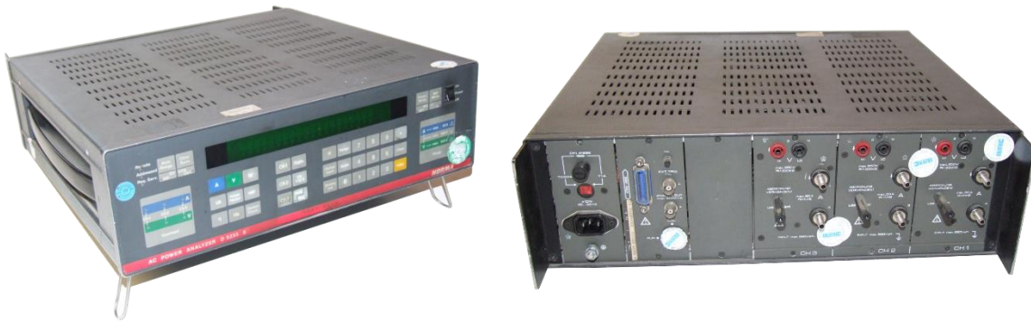
Slika 3.25 Analizator snage NORMA AC Power Analyzer D 5255 S [41]
