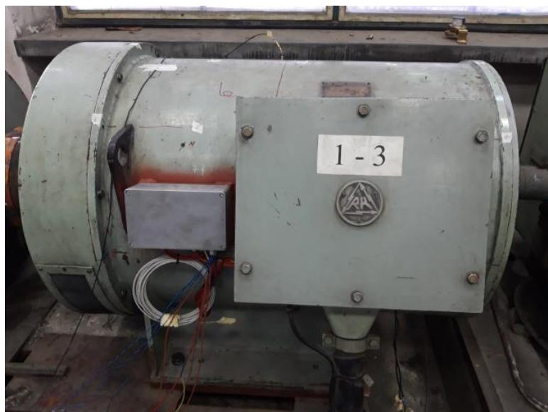
Slika 3.1 Sinkroni generator za provedbu ispitivanja
