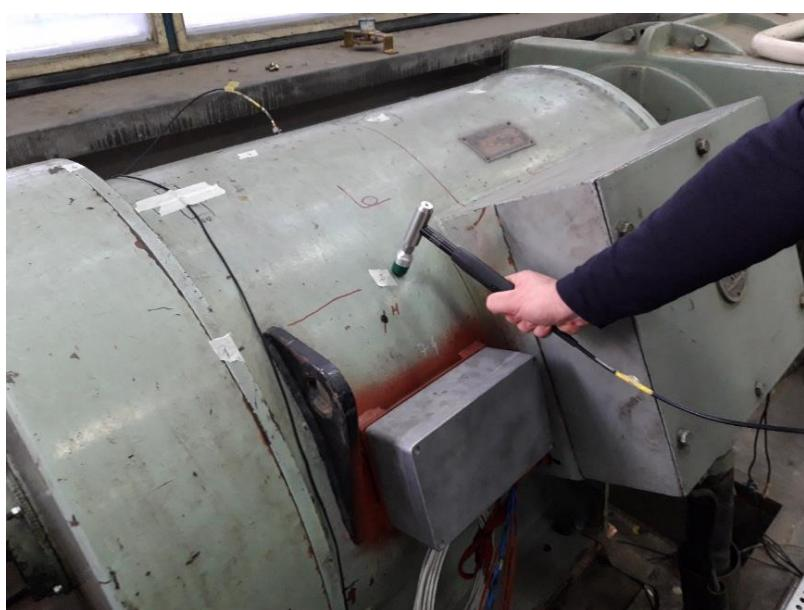
Slika 6.10 Stvaranje mehaničkog pobudnog impulsa udarcem čekićem o kućište statora
