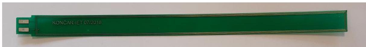
Slika 3.15 Mjerni svitak izrađen u PCB tehnologiji
