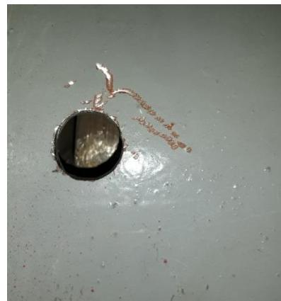
Slika 3.8 Provrt na kućištu ispod kojeg je dostupan paket statora za montažu senzora
