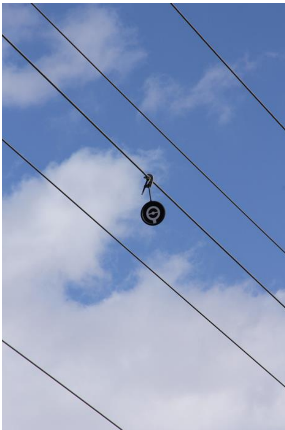
Slika 2.17 Montaža mete za snimanje provjesa i procesuiranje slike te pripadajuće ovjesne i spojne opreme
