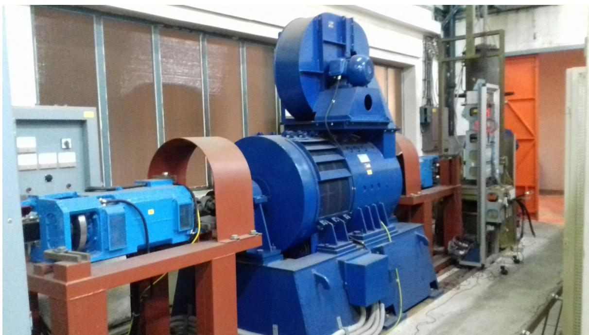
Slika 10.2. Smještaj vučnih tramvajskih motora i opteretnog stroja u strojarnici
