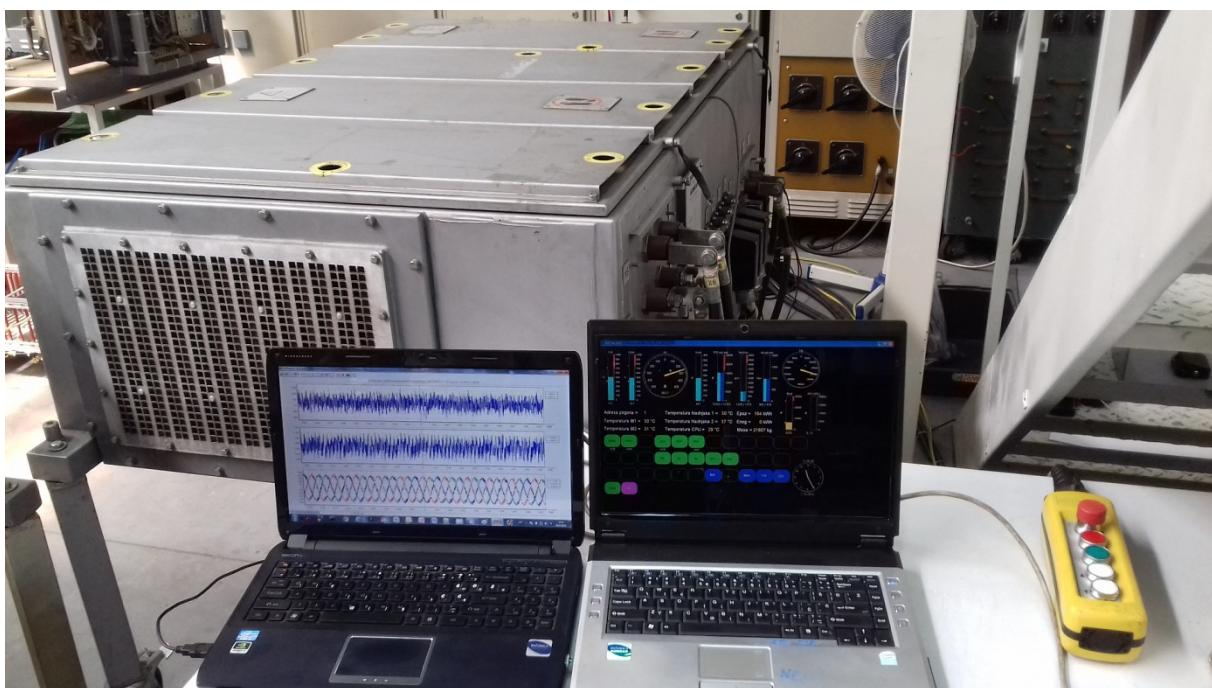
Slika 10.3. Pretvarač glavnog pogona tramvaja serije TMK 2200 za Zagreb, komunikacija s upravljačkom elektronikom i praćenje stanja pogona
