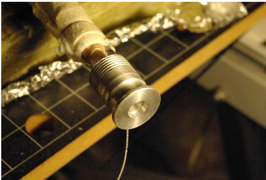
Slika 5.16. Četvrta varijanta prirubnice napravljena od tokarenog aluminija pokazala se vrlo kvalitetnom te je osigurala visoku razinu brtvljenja.
