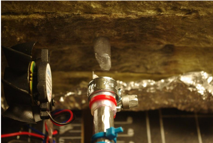
Slika 5.15. Puknuće reaktorske cijevi uslijed pretjeranog zatezanja stezaljke na trećoj verziji prirubnice.
