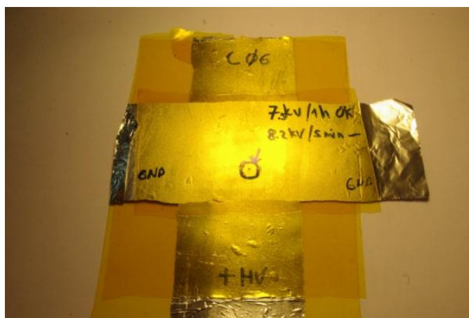
Slika 6.34. Pločasti kondenzator nakon ispitivanja probojnog napona. Strelica s krugom označava mjesto proboja. Elektrode su napravljene od aluminijske folije za kućanstvo. Na ovoj slici je testiran Kapton debljine 0,1 milimetar koji ima adhezivni sloj s obje strane.
