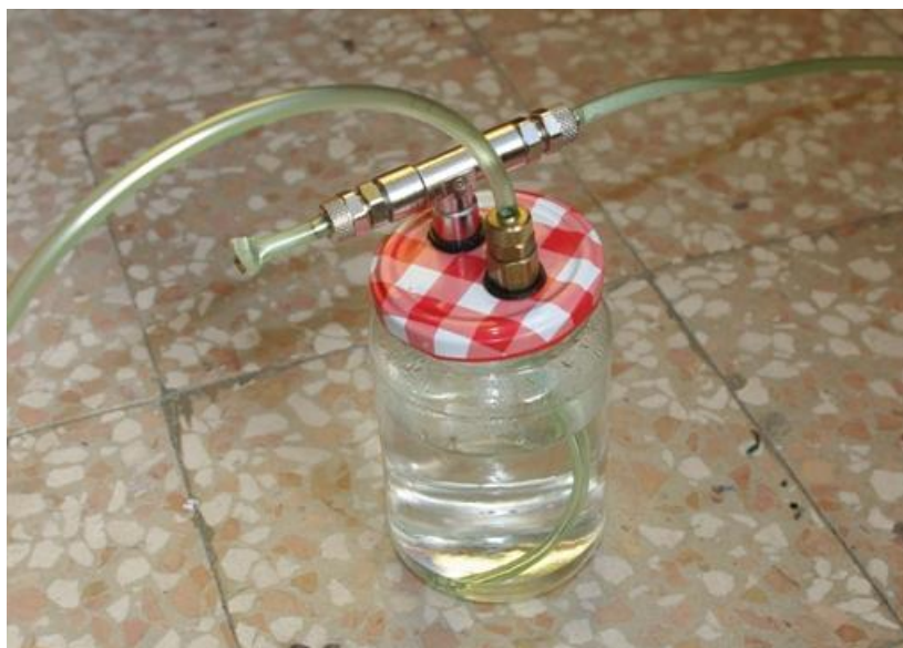
Slika 5.24. Staklenka vode kao mjerac protoka. Mjerenje se osniva na mjerenju frekvencije pojavljivanja mjehura plina koje je direktno proporcionalno masenom protoku plina.
