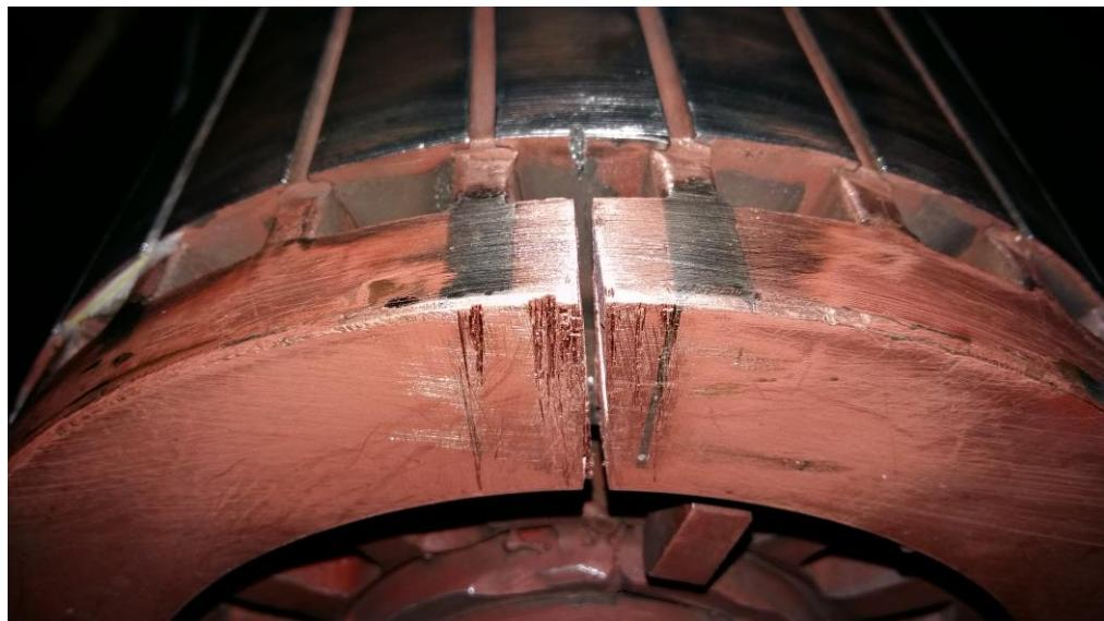
Slika 6.44 Kavezni namot – mjesto prekida prstena rotora
