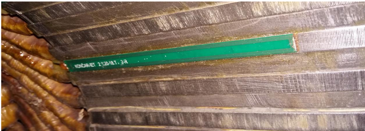
Slika 3.10 Mjerni svitak ugrađen na zub statora
