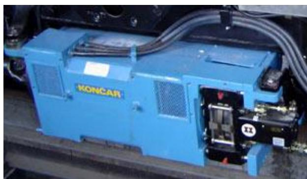
Slika 3.1 Tramvajski vučni motor
