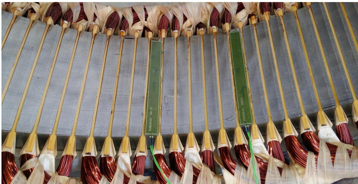
Slika 4.7 Mjerni svici za diferencijalno mjerjenje magnetskog polja ugrađeni na zube statora asinkronog motora
