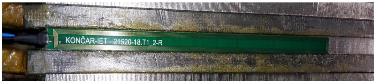
Slika 6.3 Mjerni svitak za detekciju kvara izrađen u PCB tehnologiji
