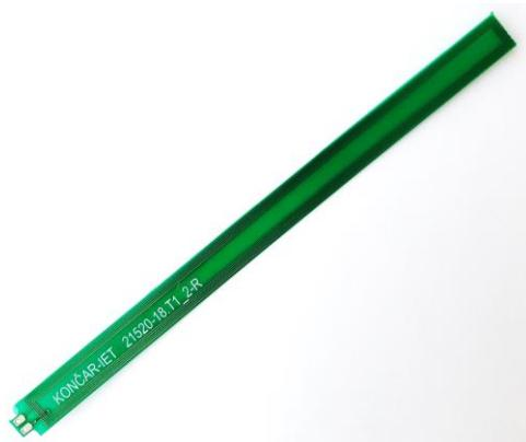
Slika 3.9 Mjerni svitak izrađen u PCB tehnologiji
