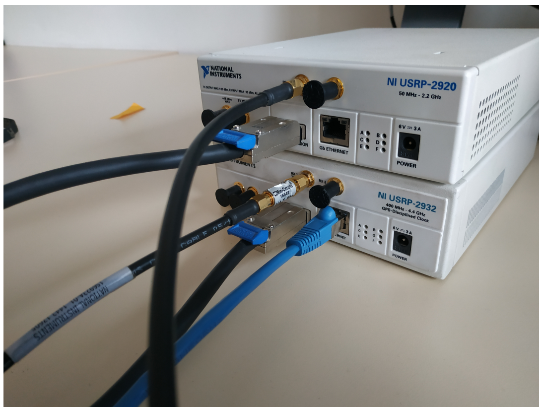
Slika 7.1: Primopredajni sustav programski određenih radija
