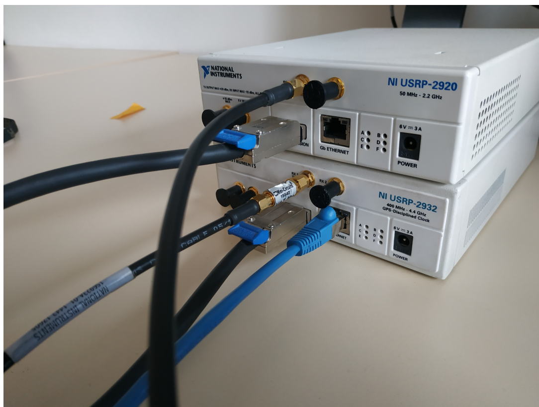
Slika 7.1: Primopredajni sustav programski određenih radija
