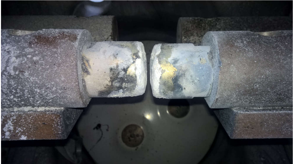
Slika 5.2.14. Izgled elektroda i lučnog prostora nakon jednopolnog lučnog kvara
