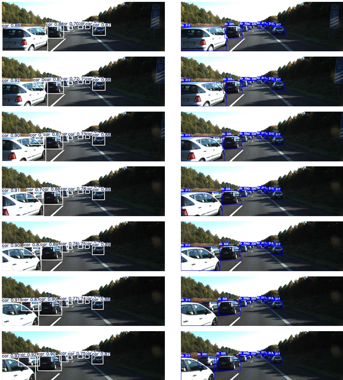
Slika 3.7. Scenarij 20 - usporedba YOLO detekcija i njima dodijeljenih ID-jeva. Lijevo: Izlaz iz YOLO modela. Desno: Izlaz iz SORT algoritma.
