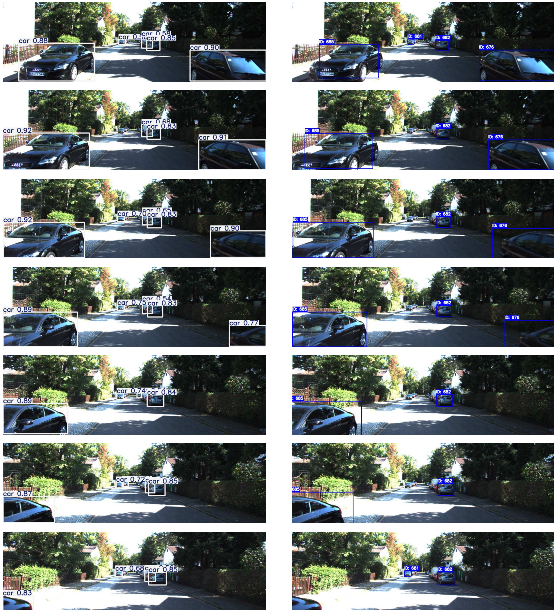
Slika 3.6. Scenarij 7 - usporedba YOLO detekcija i njima dodijeljenih ID-jeva. Lijevo: Izlaz iz YOLO modela. Desno: Izlaz iz SORT algoritma.
