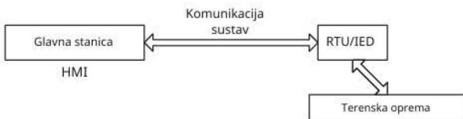
Slika 2.2 Prikaz komponenti SCADA sustava
