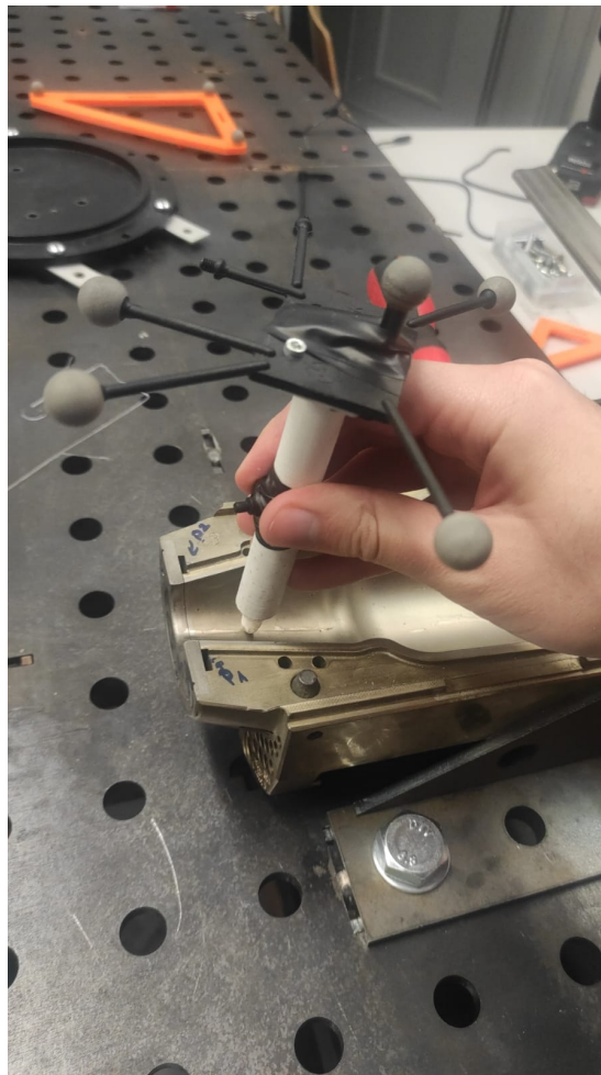
Slika 3.5: Slika specijalnog alata s optičkim markerima u procesu demonstracije brušenja po kalupu.
