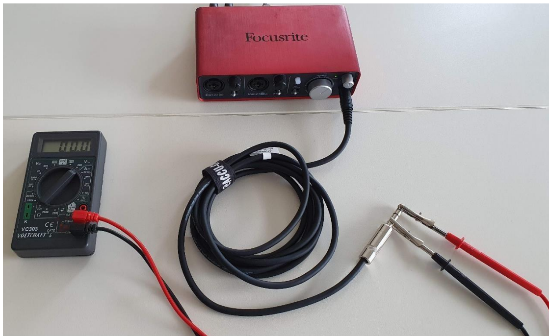
Sl. 3 - Podešavanje mjerenja izlaznog napona slušalica
