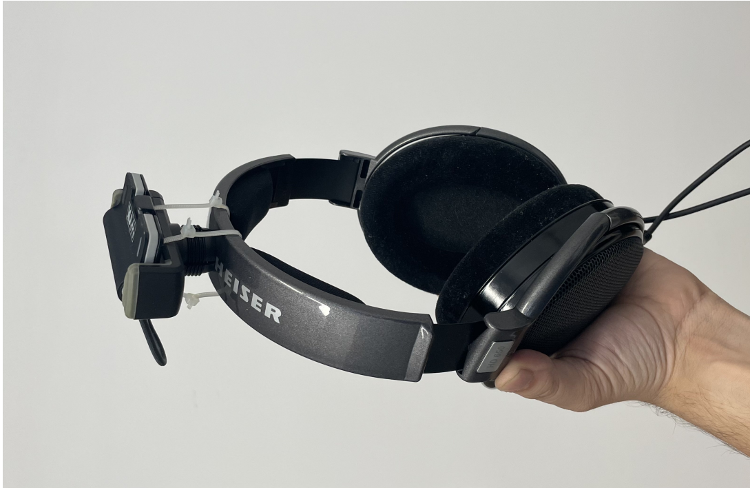
Slika 2.16: Waves NX [80] uređaj za praćenje položaja glave postavljen na slušalice binauralnog sustava.
