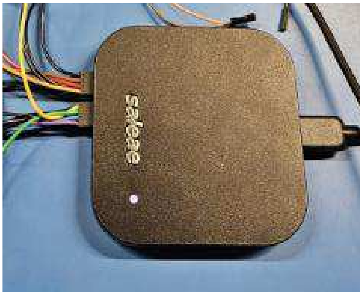
Slika 16: Saleae logički analizator
