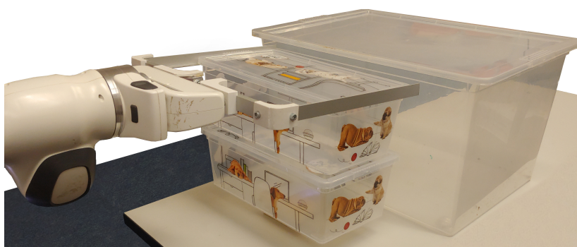
Slika 2.2: Spajanje komore za polaganje jajašaca (robot ju drži) i komore za razmnožavanje, ispod komore za polaganje jajašaca je kutija sa supstratom
