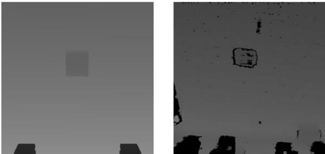
Slika 8 – primjer dubinskih slika korištenih za treniranje i testiranje modela; dubinska slika u simulaciji (lijevo) i dubinska slika realnog okruženja (desno)[5]
