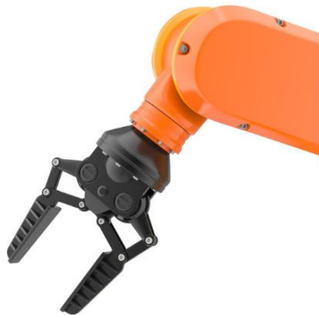
Slika 6 – primjer jednog industrijskog grippera s 2 prsta na robotskoj ruci[14]
