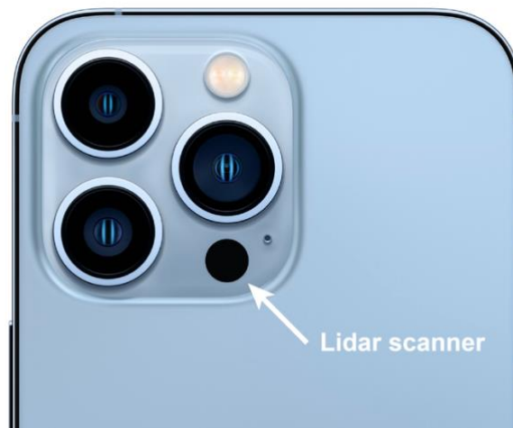
Slika 2.3 LiDAR senzor na iPhone uređaju (preuzeto iz [13])
