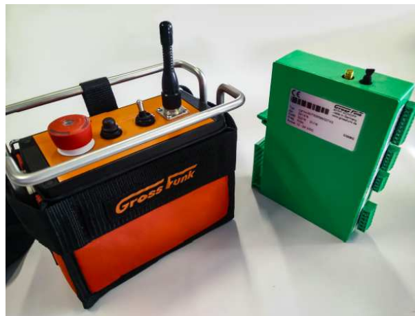
Slika 2.3. RES sustav. Odašiljač na lijevoj strani i prijarnik na desnoj.
