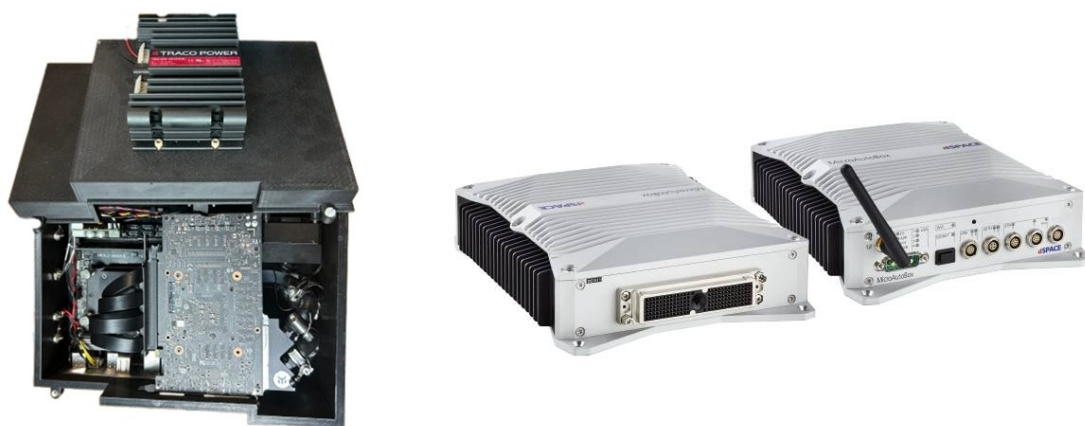
Slika 3.2. Vlastito modificirano računalo (lijevo) i MicroAutoBox III (desno).
