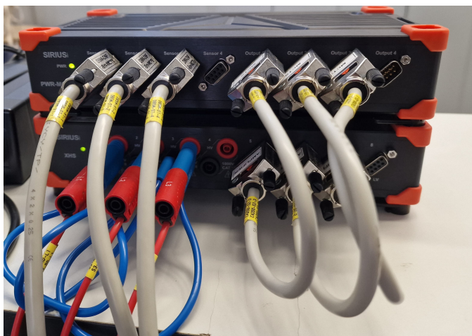
Slika 6.2. Analizator snage DEWESoft Sirius
